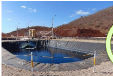
Lagoa de solução ácida diluída com água para lixiviação das pilhas (ao fundo) em circuito fechado por vários meses
