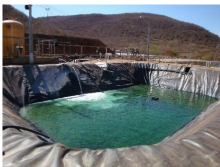
Solução rica em metais resultante da etapa de lixiviação na Planta de Testes antes de ser levada para Planta Hidrometalúrgica. Notar morro do Brejo Seco ao fundo
